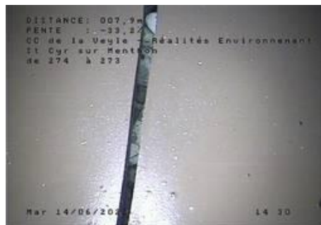
Fissure avec vide visible par le défaut- entre R274 et R273 Fissure avec vide visible par le défaut- entre R274A et R275
