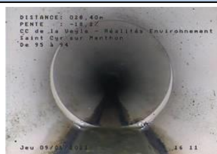
Plusieurs déplacement d'assemblage créant possiblement une perte d'effluents - R94 et R95
